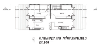
PLANTA BAIXA HABITAÇÃO PERMANENTE 3 ESC: 1/50
